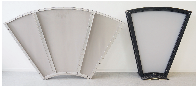
Bild 2. Die geschnittene, genietete und vergleichsweise schwere Version des Scheibenfilters aus Edelstahl (links, 60°-Element) im Vergleich zur Kunststoffversion mit Stahlblegler (rechts, 30°)
