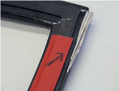
Bild 3. Verrutscht der händisch in die Maschine eingelegte Metalleinleger, kann das zu Schäden an Bauteil, Werkzeug und Maschine führen, wie das Beispiel zeigt
